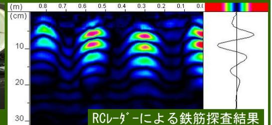
RCレダによる鉄筋探査結果
